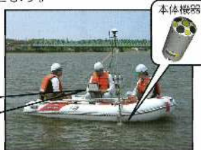
ADCP(M9)による計測状況
